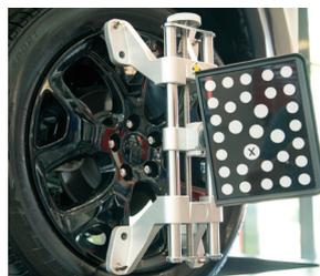
Con un design autocentrante, le unghie bilaterali garantiscono una presa solida e rapida, anche sui coprimozzo.
